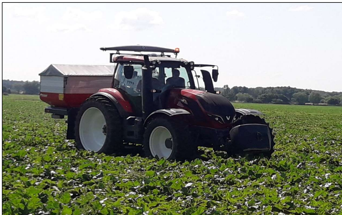
Pořízená inovativní aplikační linka pro realizaci vyvinuté technologie řízeného přihnojení porostů cukrovky dusíkem ve variabilní dávce podle diagnostikovaného rozsahu
