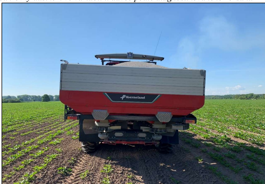
Aplikační rozmetadlo je v dávce hnojiva řízeno automaticky optickým senzorem snímající výživný stav porostu dusíkem, změna dávky hnojiva je v reakci do 3 s od poskytnutí informace senzorem
